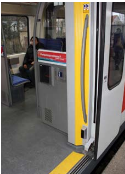
Einstiegsbereich: Die Türen der S-Bahn Züge sind gelb markiert, damit die Fahrgäste beim Einsteigen die Lichtschranken zum Schließen der Türen nicht blockieren.
